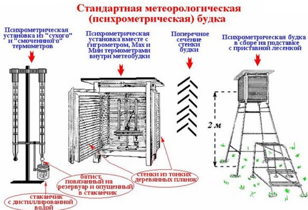
Рис. 3. Психрометрическая будка (общий вид)
